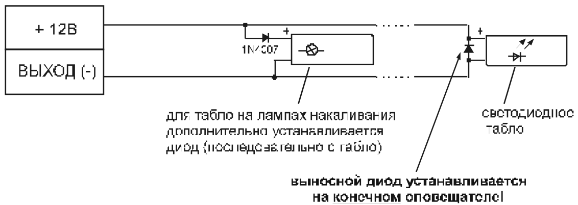
Рис. 6.1. Схема подключения нескольких световых табло
